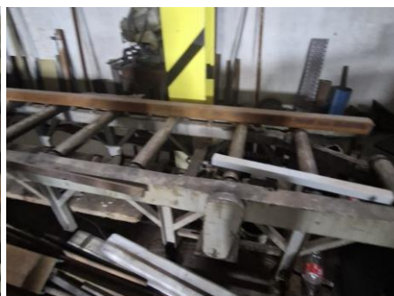
9. Stol za prijenos materijala sa valjcima uz tračnu pilu
