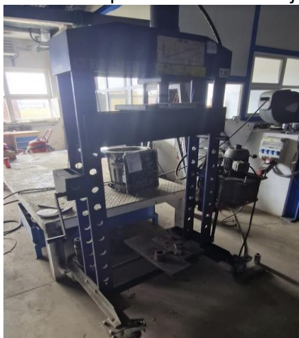
7. Hidraulična preša 50 T OMA serijski broj P77578F
